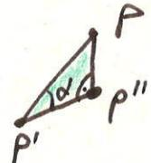
$H$  mit  $\angle(P'', P', P) = \alpha$  Schenkelwinkel von  $H$  mit  $H_2$ , unabh. von  $P$ !
